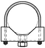
Mastschelle Edelstahl v2a / feuerverzinkt, für Mastdurchmesser
